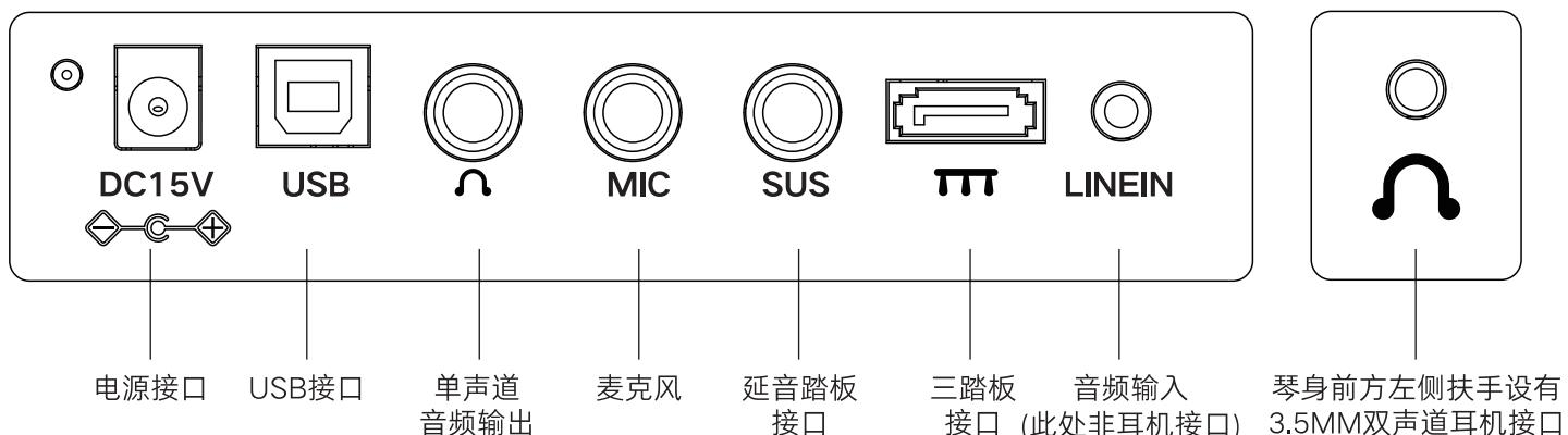
注意：耳机需连接设备前端3.5mm接口，插错位置可能导致外放。
