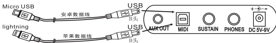
2、手机连接好后打开“POP Piano APP”学习软件然后按照手机的提示进行下一步的连接操作直至连接成功(如下图)。
