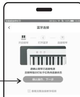
步骤4:点击手机的这个图标确认下一步操作。
